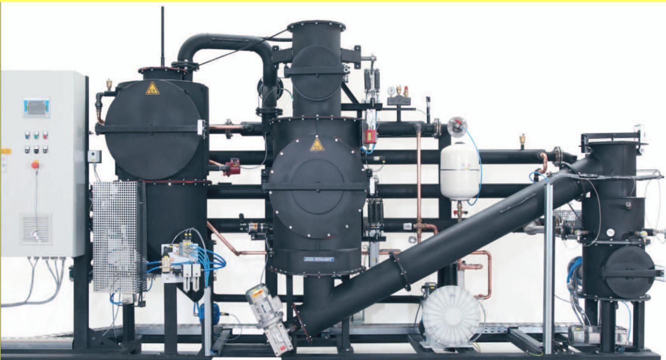
Holzkraftwerk zur Erzeugung von Strom, Wärme und Kohle
